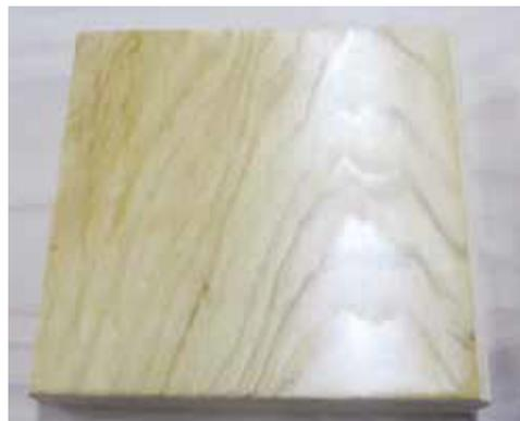
図-3. 塗装後の圧密処理材
