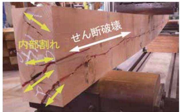
写真-1. 木口面の内部割れとせん断破壊の状況
