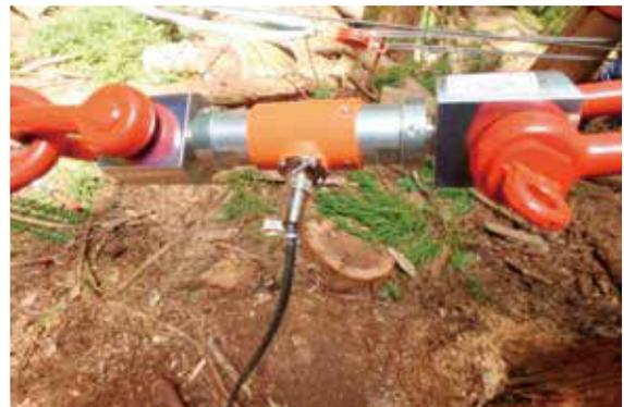
立木とワイヤーロープの間に荷重計を取り付けて、引張荷重の測定を行います。
