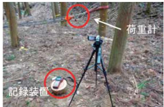
荷重計につながれた記録装置に引張荷重の変化を記録します。同時にビデオカメラで立木の倒れる様子を撮影します。
