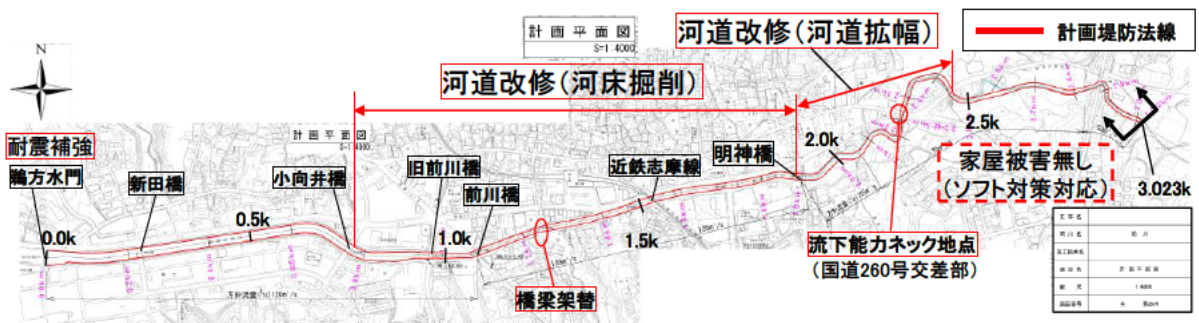
図 河川工事の施工の箇所位置図
