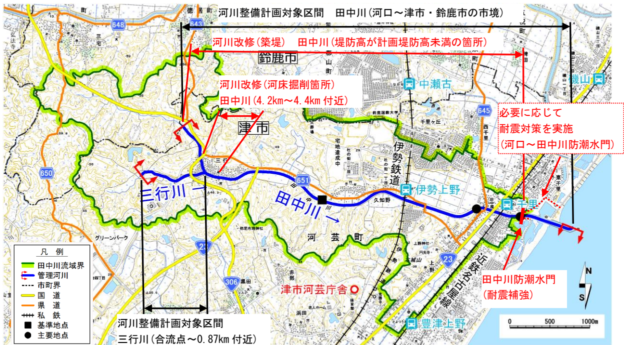
図 4.1 河川工事の施工の箇所位置図
