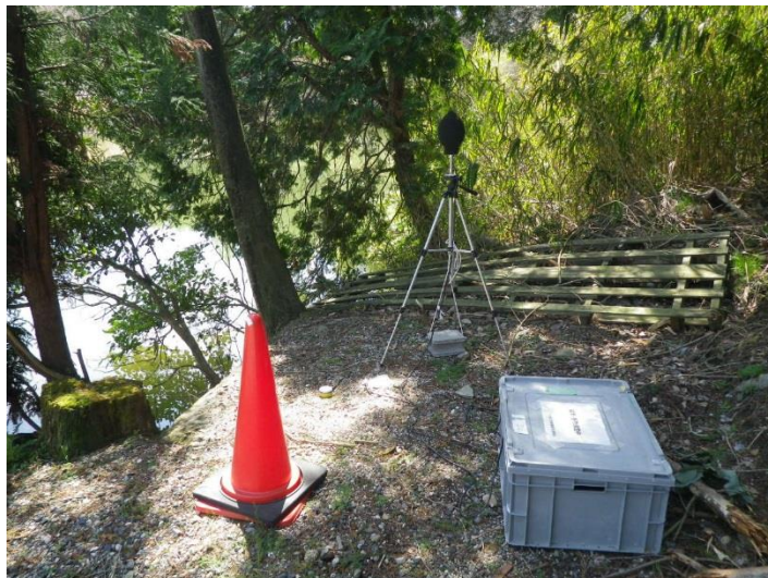
資料 6-1 工事中の騒音・振動調査風景 (H29. 4. 13~14 : K-6)
