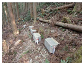
土砂受け箱を設置し、土砂流亡量を継続調査
