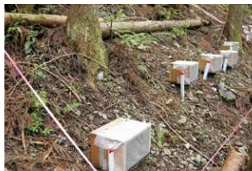
土砂受け箱設置による調査
