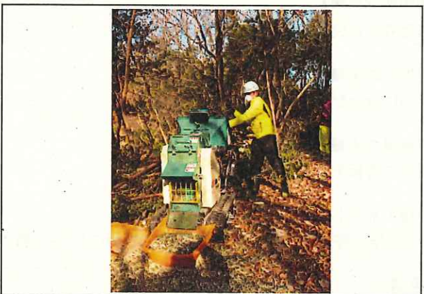
写真6 チップーシュレッダー施工状況
