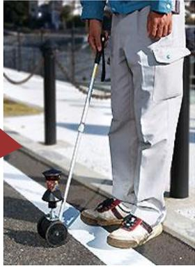
このような器具と自動追尾TSを用いれば比較的短時間で面管理のための計測が可能
