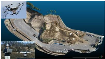
UAV等による写真測量等により、短時間で面的(高精度)な3次元測量を実施。
