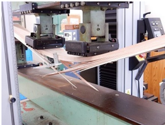
ヒノキラミナの曲げ強度試験 (曲げヤング率の測定)
