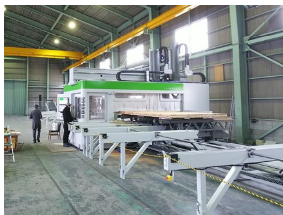
木材加工流通施設の整備（CLT加工機：いなべ市）
