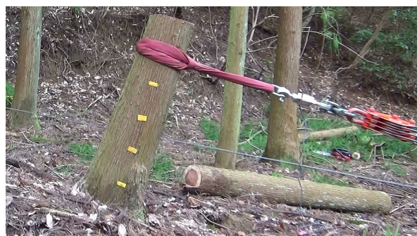
立木の引倒し試験の様子
