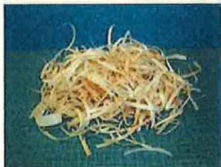
ヒノキ材 スライス片 (幅 5mm、厚さ 0.1-0.3mm、長さ 50-400mm)
