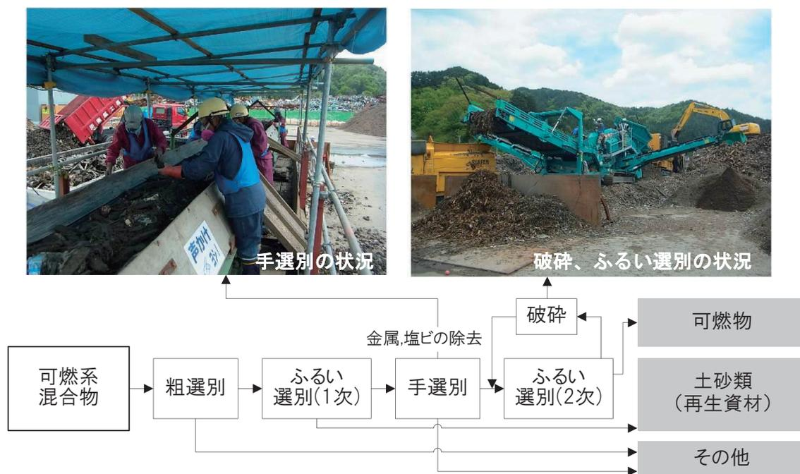
図2-3-6 二次選別の手順例（可燃系混合物）
