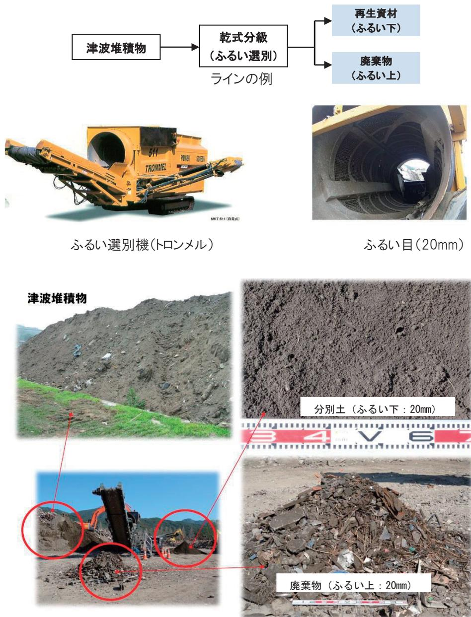
図 2-3-11 津波堆積物のふるい選別（乾式分級）の例
