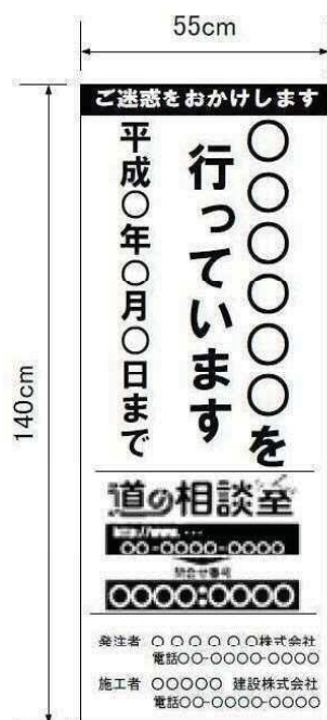
(様式4) 工事説明看板 (占用企業工事)
