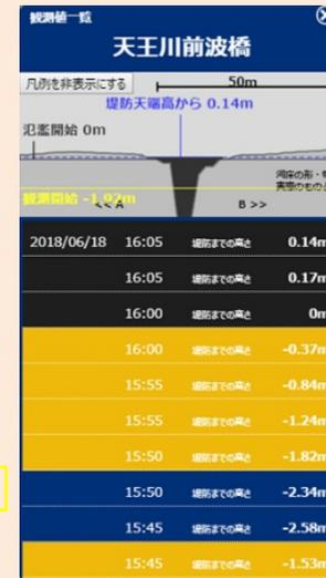
河川横断図初期状態では、最新の河川横断図を表示します。観測値一覧の行を選択すると、そのときの河川横断図を表示します。
