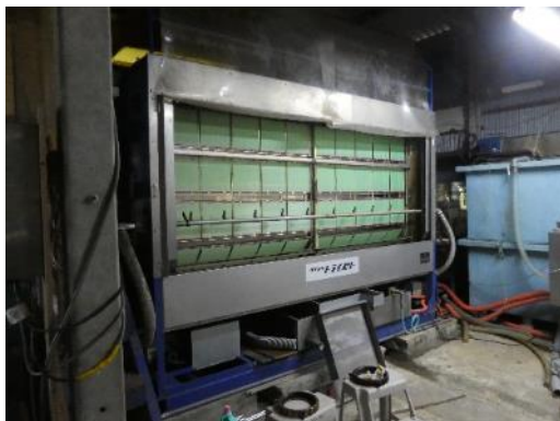
図 3. 10 連全自動乾燥機（2 経営体が使用）
