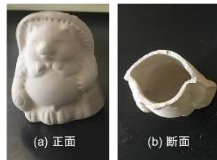
図4 開発したスラリーを用いて作製した鋳込み成形体
