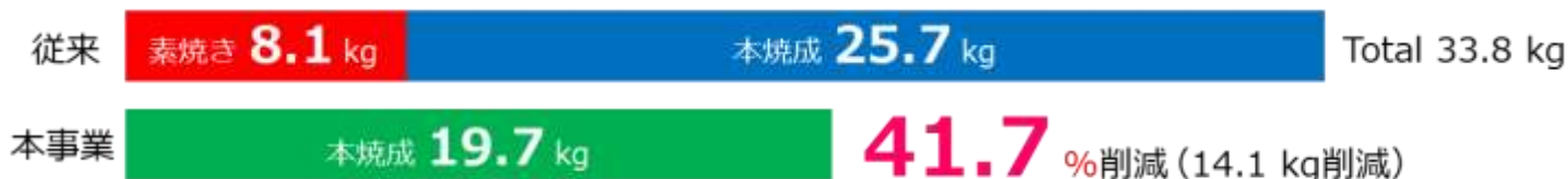
図7 陶磁器の焼成パターンの違いによるプロパンガス使用量
