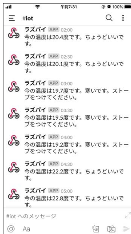
図 4 スマートフォンへの温度データ通知
