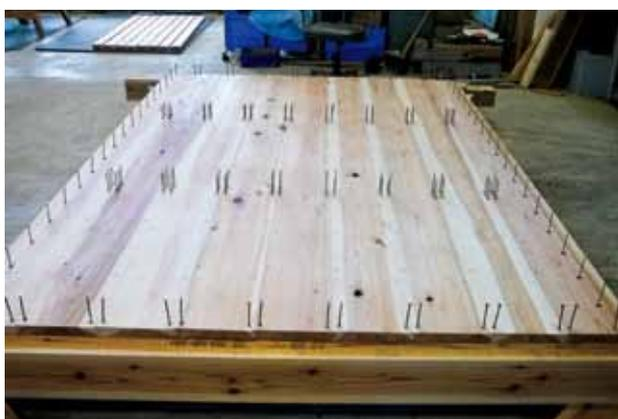
試験後の床構面に大きな損傷は見られませんでした。
