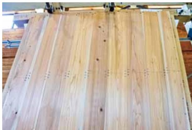
加力中の厚板は釘などで梁桁に固定されています。
