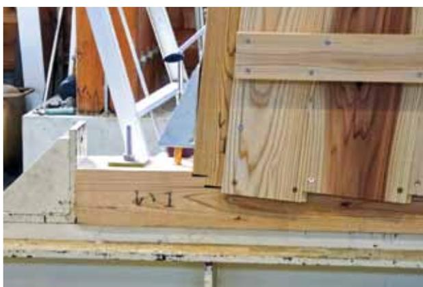
最終加力後の床部材は大きく変形しています。
