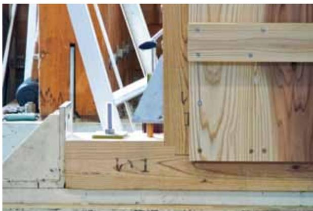
試験前に装置にボルトで床部材を固定します。
