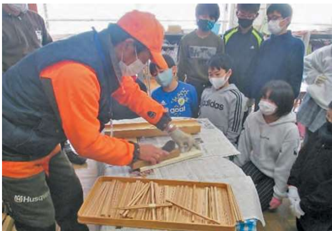
治具とカンナを使った箸の形の整え方の説明
