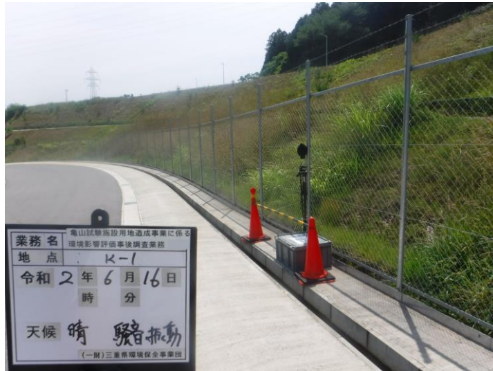
写真 1-1 騒音・振動調査状況 (K-1 : 令和2年6月16日)
