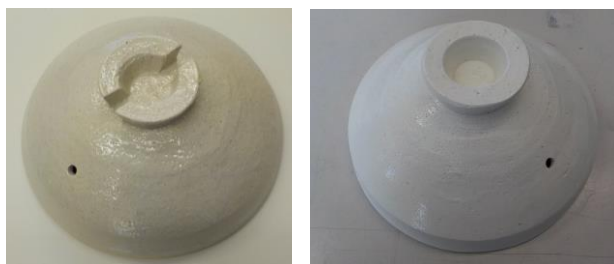
図5 現行伊賀焼土鍋蓋（左）と開発品（右）の外観比較
