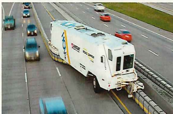
利用時間帯や交通状況に応じた 可変式道路構造：リバーシブルレーン (アメリカ合衆国テキサス州)
