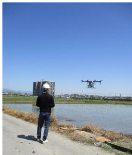
ドローンを用いた 防除剤の散布
