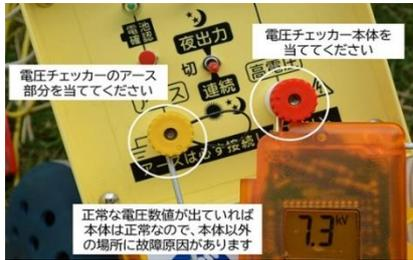
本機にセットされているワイヤーをはずし、テスターで電圧を点検して下さい。
