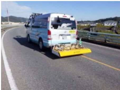
図II-10 床版点検車とその解析画像
