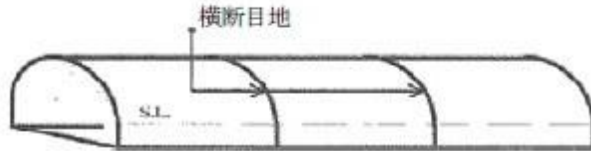
山岳トンネル工法（覆工打込み方法：全断面）の例
