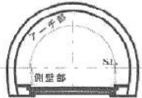
山岳トンネル工法（覆工打込み方法：全断面）の例
