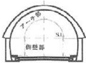
矢板工法（覆工打込み方法：逆巻き）の例
