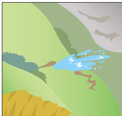
斜面から水がふき出す。
