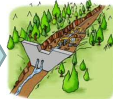
砂防堰堤堆積土砂撤去
