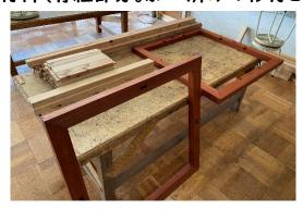
骨組・・・杉 (廃材を使用。SDGsの取組とも言えます)、パドック (アフリカ産。写真の赤い正方形の枠を作った材料です。)、9mm 合板仕上げ材・・・ガルバニウム鋼板
