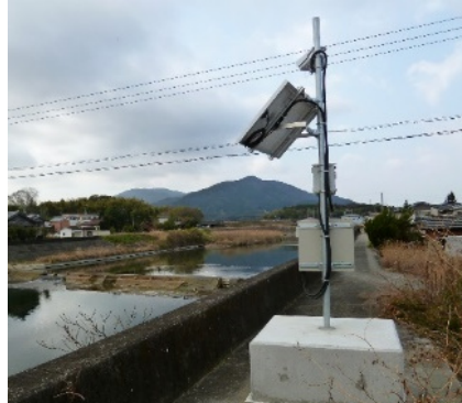
簡易型河川監視カメラ （三重県）
