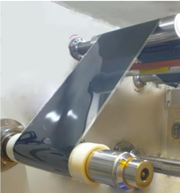
ロールtoロールによる製造 出所：積水化学工業（株）HP
