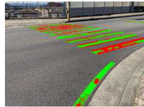
AIによる路面標示の抽出・劣化状況の判定
