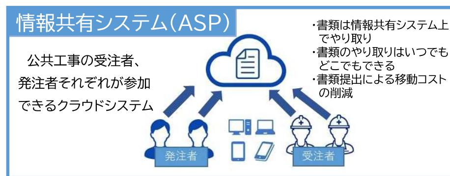
情報共有システム(ASP)の積極的な活用により施工管理を効率化
