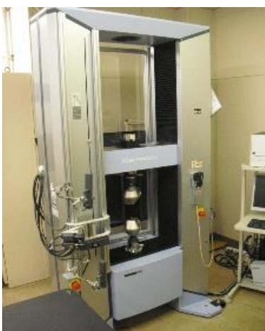
メーカー名: 島津製作所 型式: AG-100kNXplus 用途: 工業材料及び製品の強度 (引張、圧縮、曲げ等)を測定
