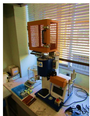
メーカー名: 東洋精機製作所 型式: G-02 用途: 主に高分子材料の流動性 を測定
