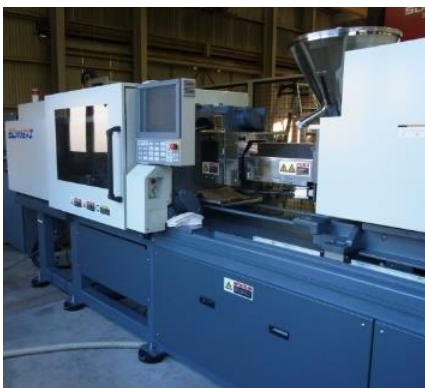
メーカー名: 芝浦機械 型式: EC100SXII 用途: 射出成形法による熱可塑性樹脂の成形
