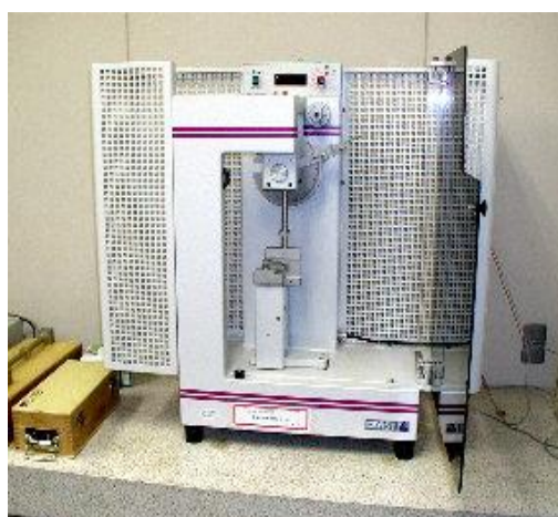
メーカー名: CHEAST 型式: Resil-25 型 用途: 主に高分子材料のシャルピー 衝撃強さを測定
