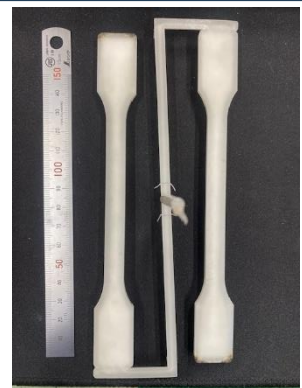
JIS K 7139 多目的試験片 A1
