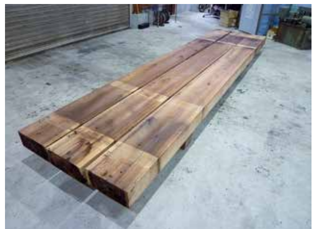
写真-1. 人工乾燥後のスギ材表面の様子
