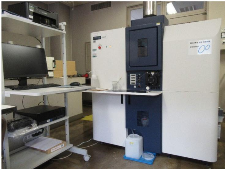
図1 真空紫外 ICP 発光分光分析装置
