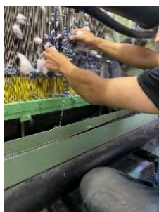
タオル織機(スプリング)に綿埃が大量付着
