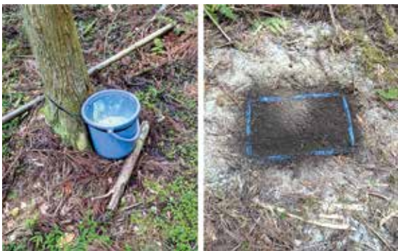
写真-1. 食塩と水を入れたバケツ(左)と食塩と土を入れた容器(右)
