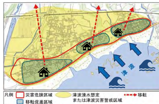
凡例 □ 災害危険区域 □ 津波浸水想定 または津波災害警戒区域 □ 移転 図A: 移転元地防御のためのハード整備を伴わない移転のイメージ
