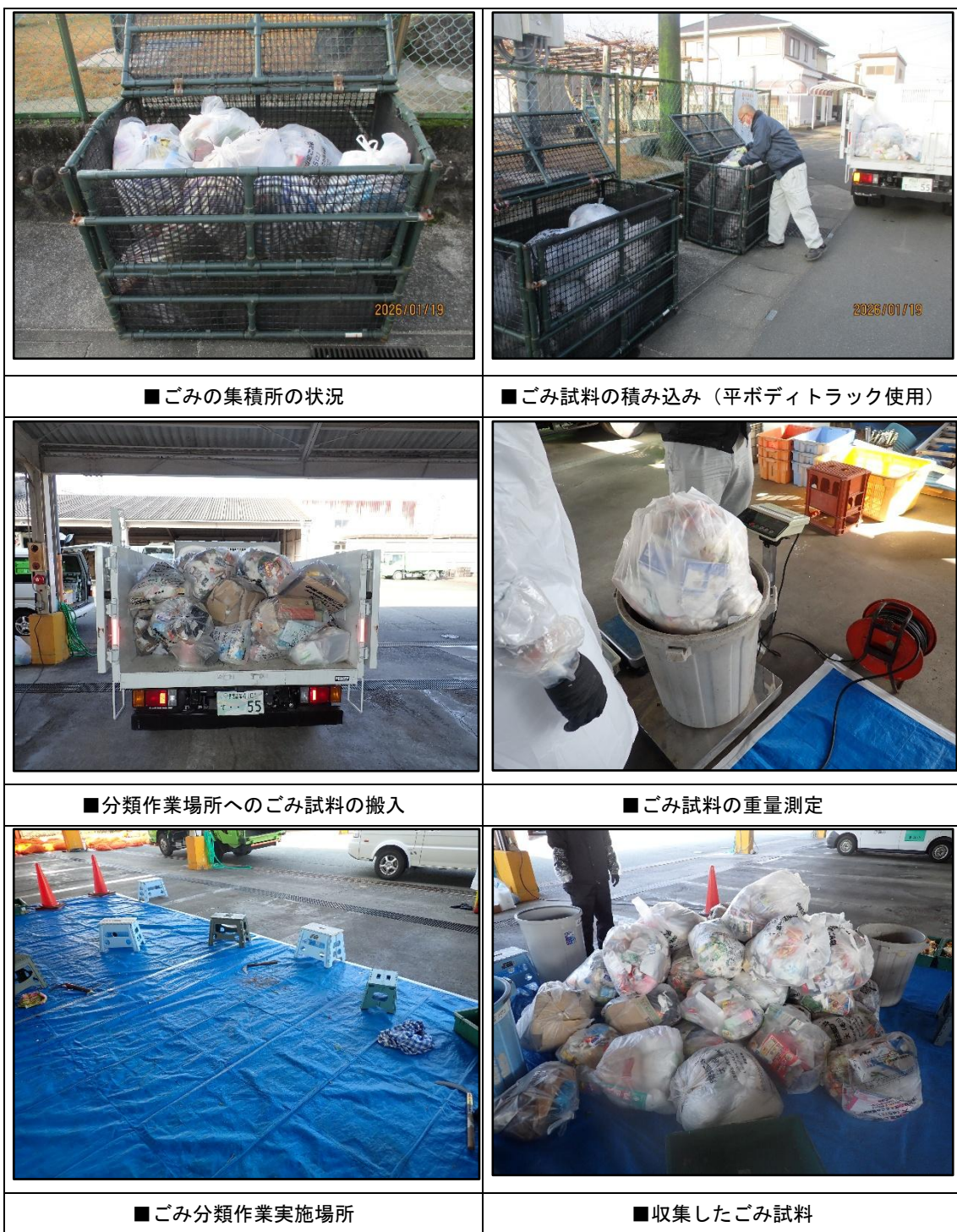
写真1 家庭系可燃ごみ試料の収集・搬入・重量計測の様子
