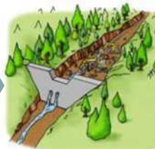
砂防堰堤堆積土砂撤去
